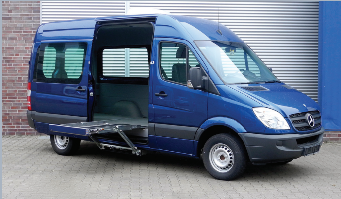
Der K90 bietet eine automatische Abrollsicherungs-klappe und eine große Hubplattform auch für breite Elektrorollstühle.
